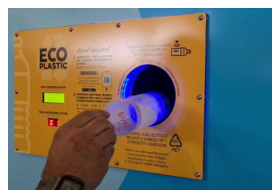
Introduzione bottiglia e lettura codice PET
