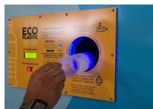
Introduzione bottiglia e lettura codice PET
